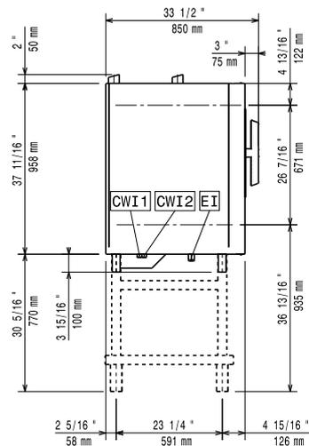
CWI1 = Kaltwasserzulauf                      EI = Elektroanschluss
